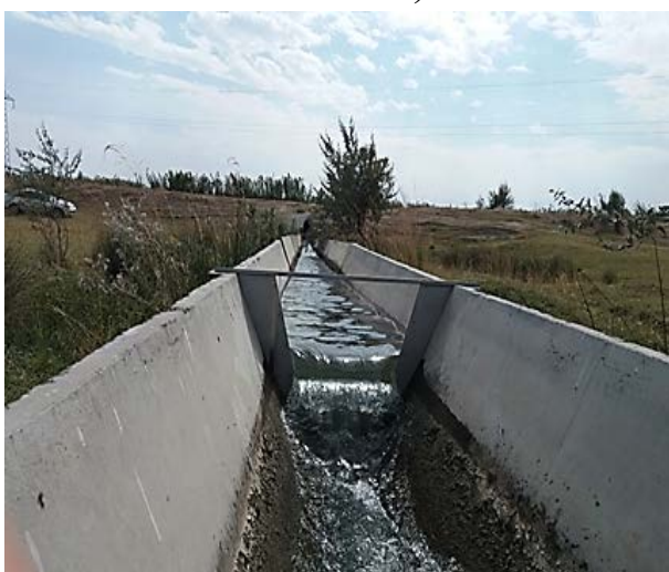
Рис. 2.8. Переносные водосливы трапецеидального (а) и параболического (б) сечений в работе (лотки работают не полным сечением).
