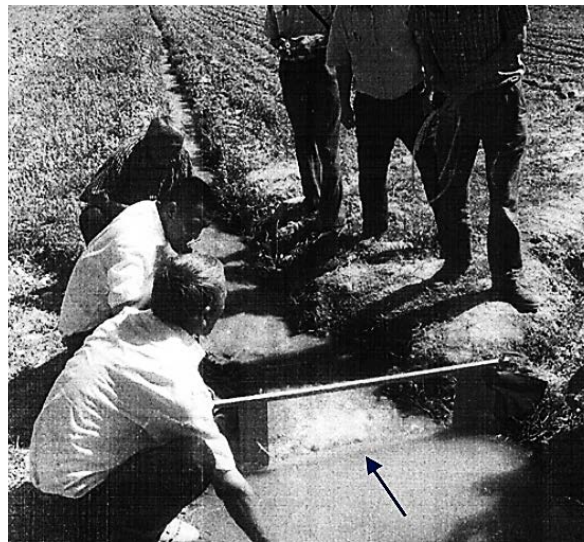
Рис. 2.1. Переносные водосливы в работе.
