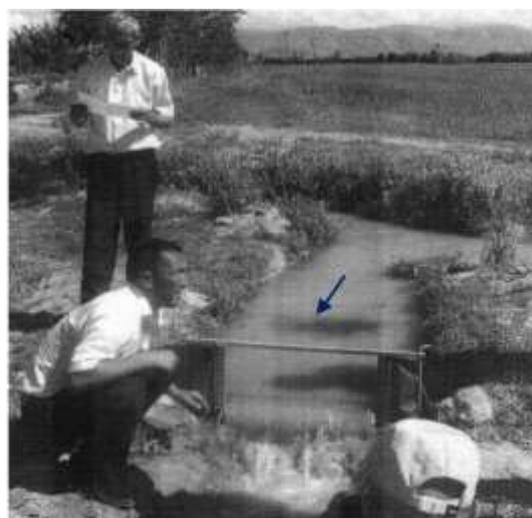
Рис. 3.2. Переносные водосливы Сатаркулова для оросителей младшего порядка. а – вид с верхнего бьефа; б – вид с нижнего бьефа.
