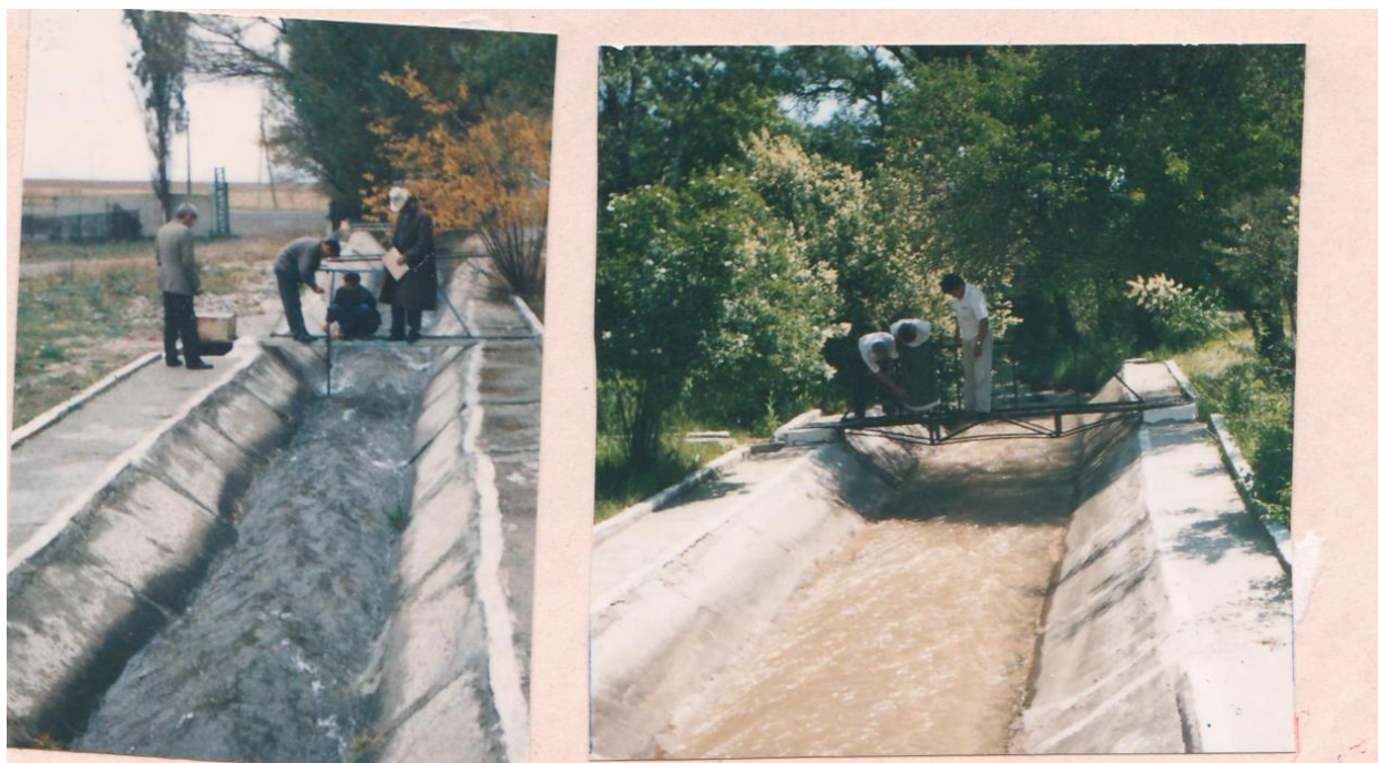
Рис.12.3. Градуировка гидропостов на каналах с.р. Аламедин при помощи гидрометрической трубке «ЗАМА».
