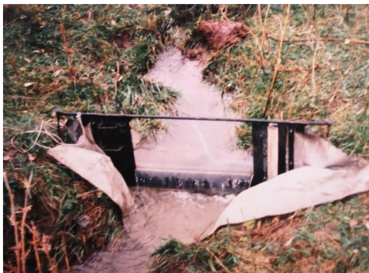
Рис. 9.8. Переносной водослив С.Сатаркулова в работе. Вид с нижнего бьефа.
